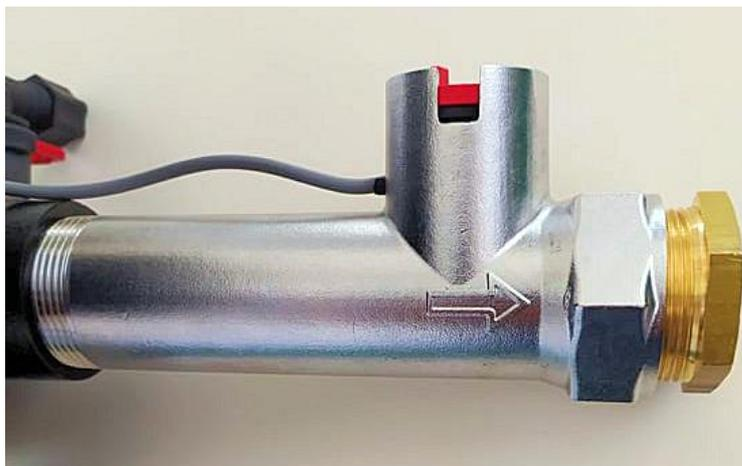
La turbina e il sensore sono orientati verso il flusso d'acqua, il quale fa girare la turbina con all'interno 2 piccoli magneti. I magneti permettono al sensore d'inviare impulsi elettrici al circuito centrale del computer. Il computer conta gli impulsi e li converte in litri. Il sensore è posto in un contenitore isolato che non lascia passare polvere, umidità e lo preserva dalla corrosione.
